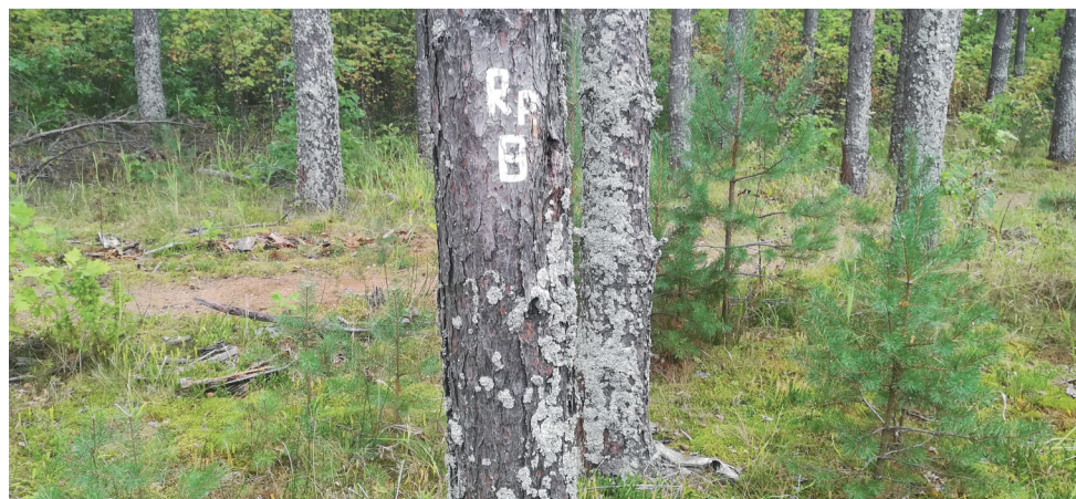
Реперный знак контрольной точки измерений на стационаре
