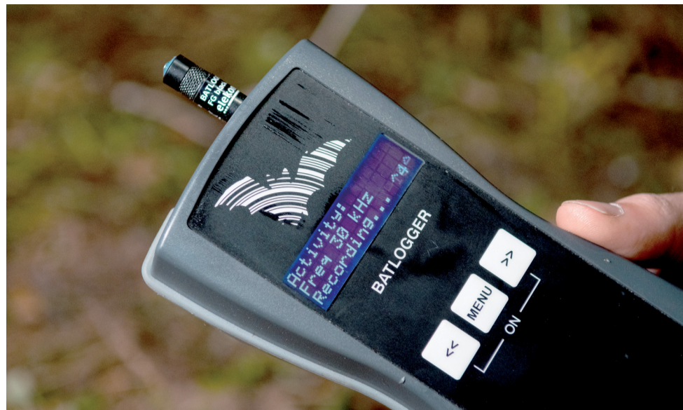
Специальный автоматический прибор BATLOGGER для маршрутных учетов летучих мышей. Он слышит, определяет вид и координаты места встречи зверьков
